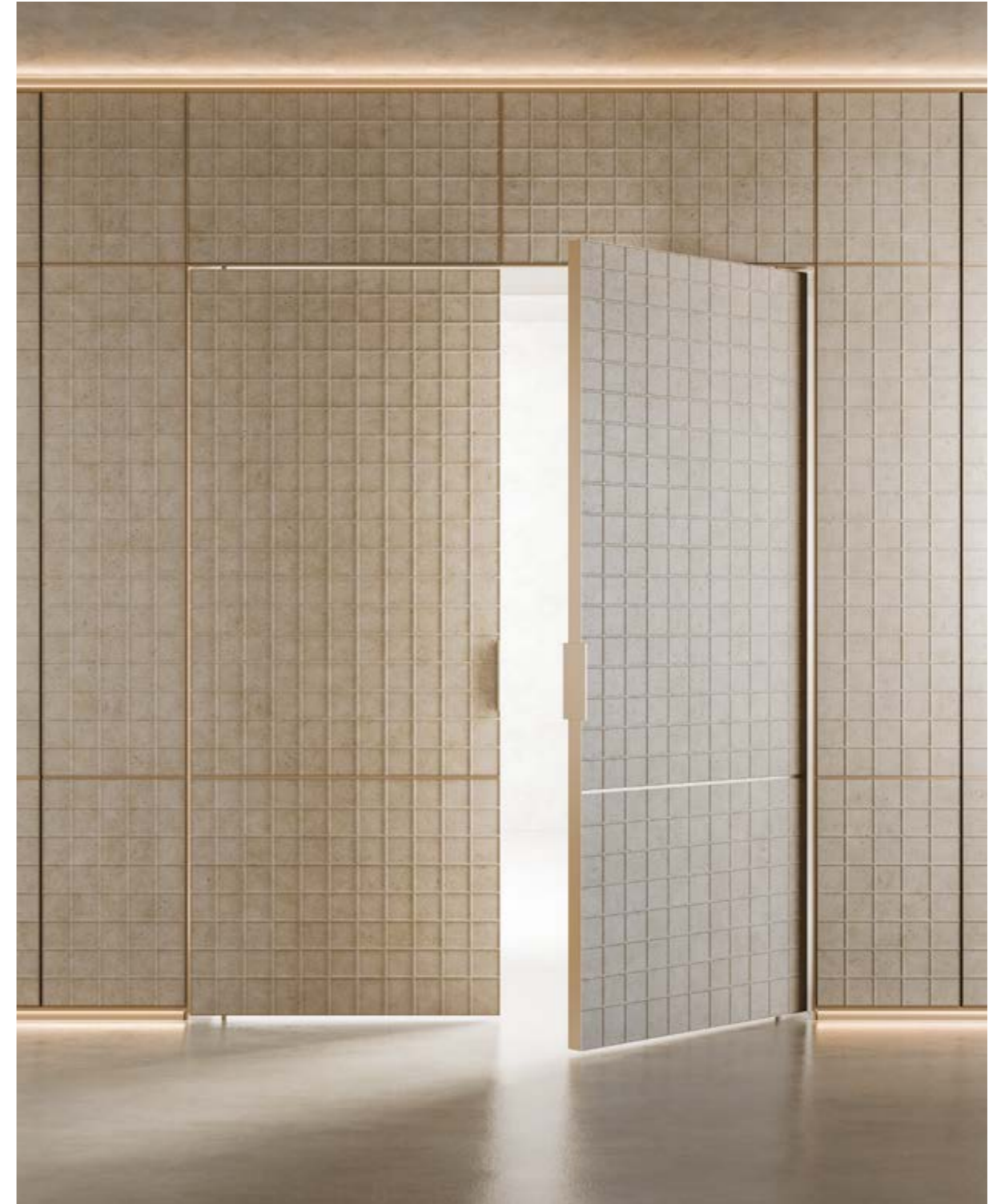
Portale pivot doppio intelaiato con sopra luce integrato nella pannellatura boiserie. I pannelli in cemento, caratterizzati da un disegno a griglia di linee in rilievo, si estendono con ritmo continuo dalla boiserie alle ante della porta, seguendo le fughe della pannellatura e creando una superficie architettonica unitaria e ininterrotta lungo tutta la parete.
